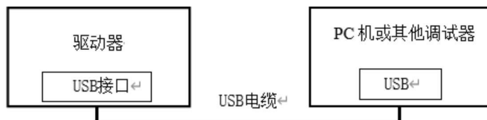
参数调试接线示意图
